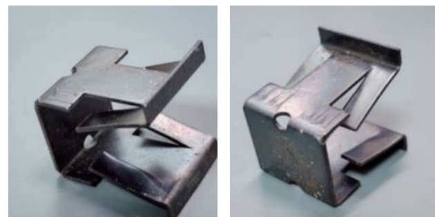
&lt;그림 5&gt; ‘ㄷ’자 체결 클립의 형상
