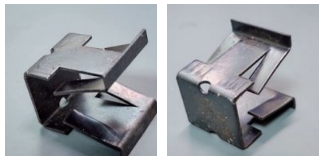
<그림 5> ‘ㄷ’자 체결 클립의 형상
